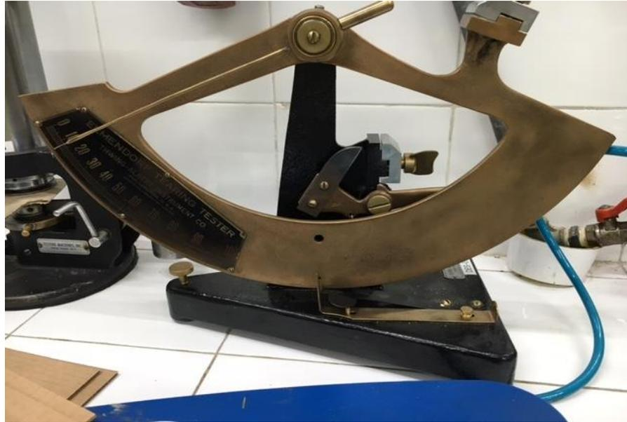
Desgarro – Mide la resistencia al desgarro, no ruptura, es como el abre fácil
