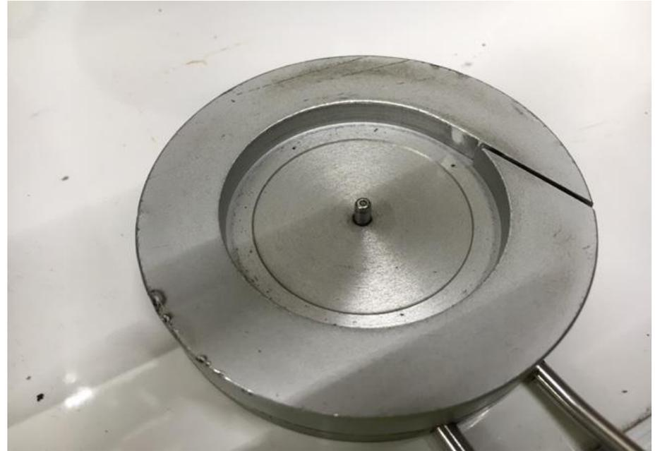
El RCT – Rign Crush test mide la resistencia de los papeles liners y el
